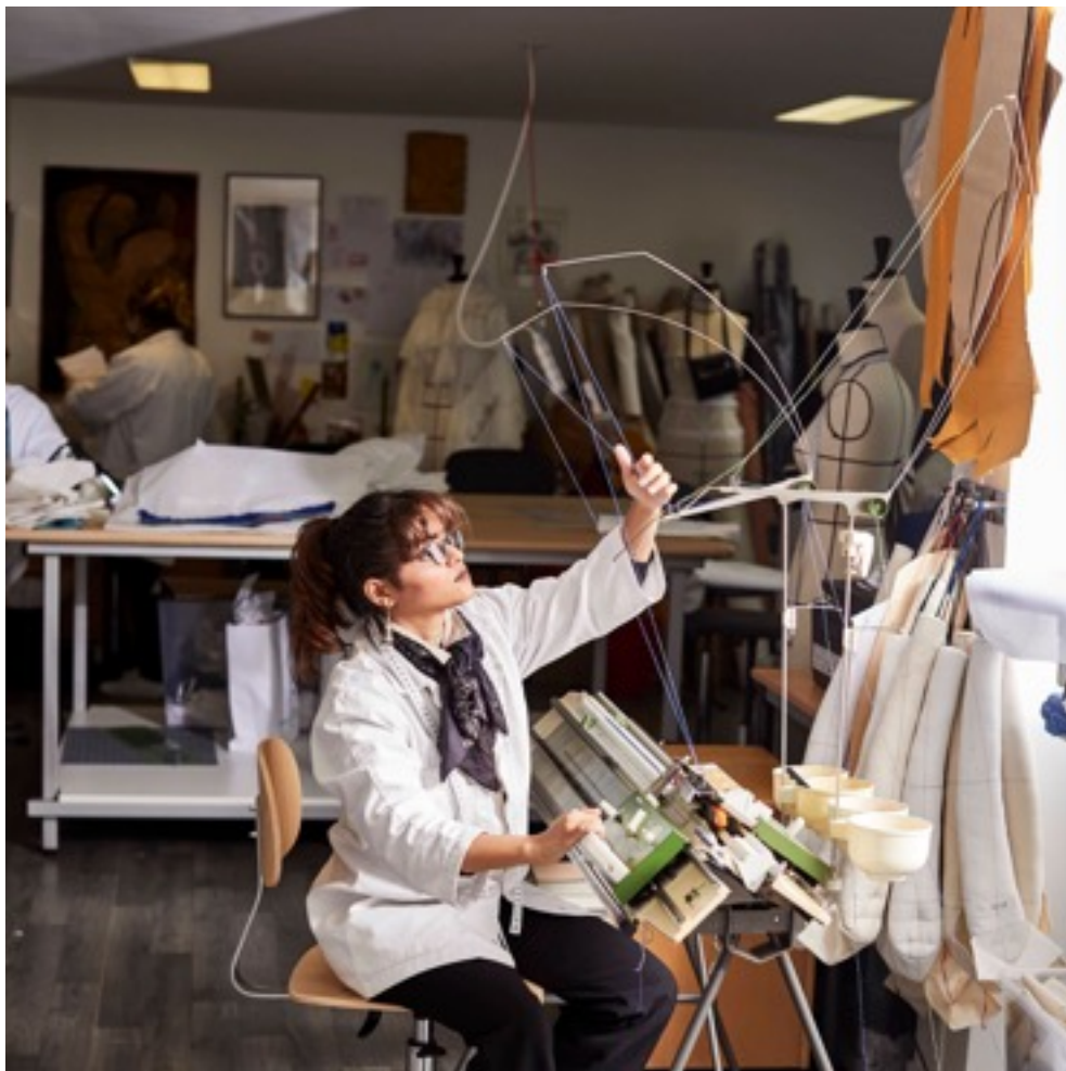
Pragya Dokania, stagiaire chez Renaissance, a détricoté à la main plusieurs pulls qu'elle commence à reconstruire grâce à la machine à tricoter mécanique.
